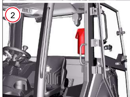
Att. 3: Ugunsdzēsamā aparāta montāžas vieta
