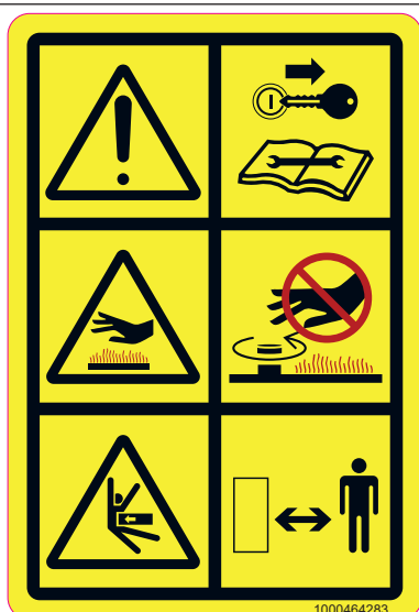
Att. 21: Drošības norādījumi uz dzinēja pārsega
